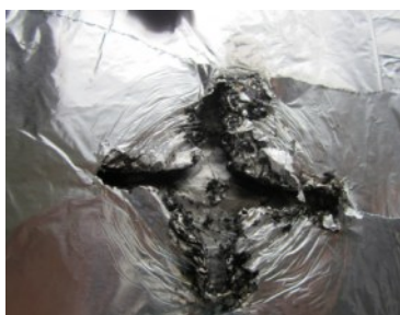
图4 元件内部局部击穿短路图
