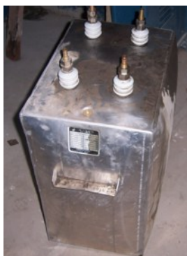
图3 局部放电产气、壳体鼓胀渗油图
