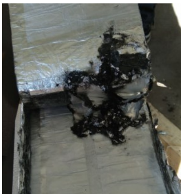
图2 聚丙烯薄膜受热老化起皱、分层图
